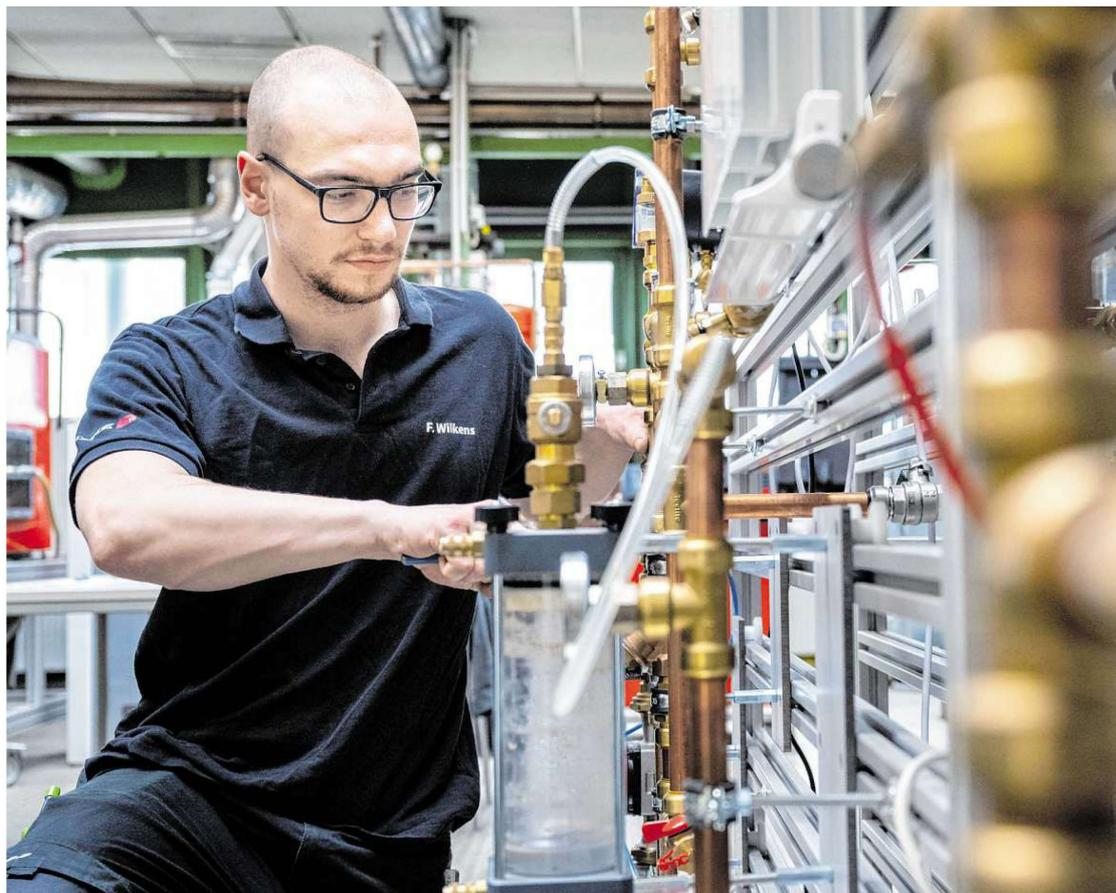
Florian Wilkems, Auszubildender im Bereich Anlagenmechaniker, an einer Schulungseinheit für den hydraulischen Abgleich einer Heizungsanlage.
